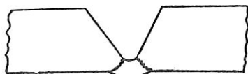
(b) バッキングリングを熔したところ Fig. 5 特殊バックリング使用法
