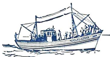
“Pelora da Costa”号。カミンズ・エンジンをつけたポルトガルの鰯船の1隻です。
