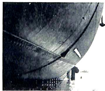
亜鉛・アルミ合金陽極のZAP-Aを使用中の船舶
