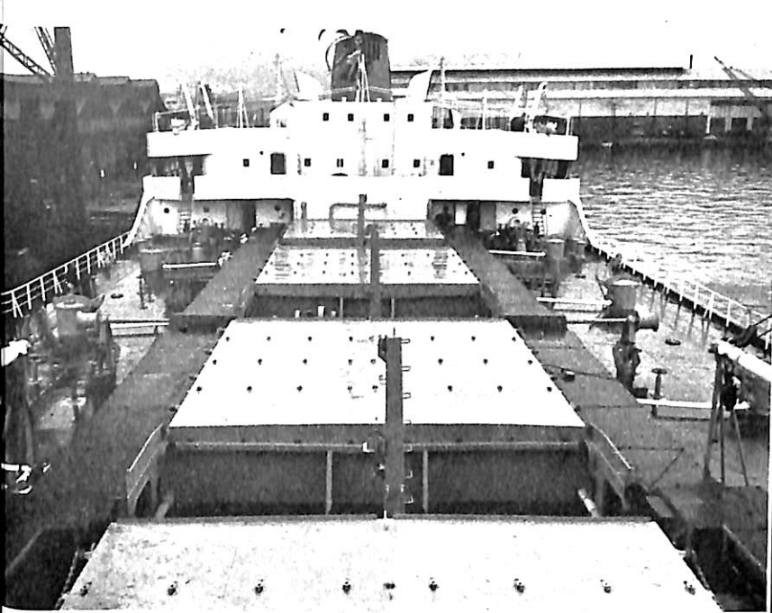
船橋より後部上甲板をみる。艀口は4ケで single pull type の Mac Gregor 式 hatch cover を備えている。Hatch の両側は好天時の連絡通路で、その下に 荷油管等の諸管や電線が通っている。
