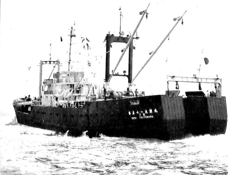
第五十一大洋丸の船尾 Slip Way と Gantry 型の Gallows, 後部島居型橋の前に煙突がある。
