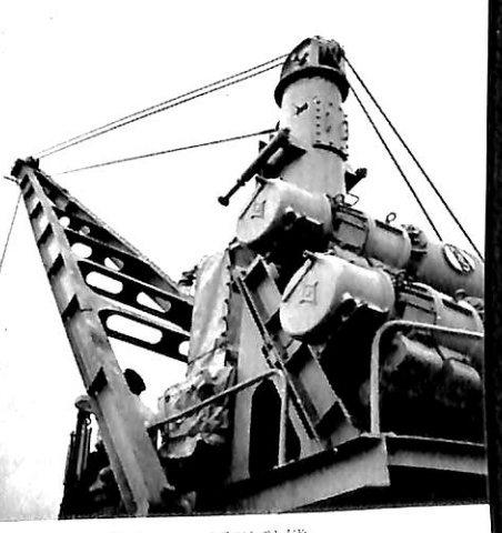
ジブクレーン用電動機
