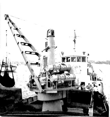
第2船口よりの荷揚中のジブクレーン
