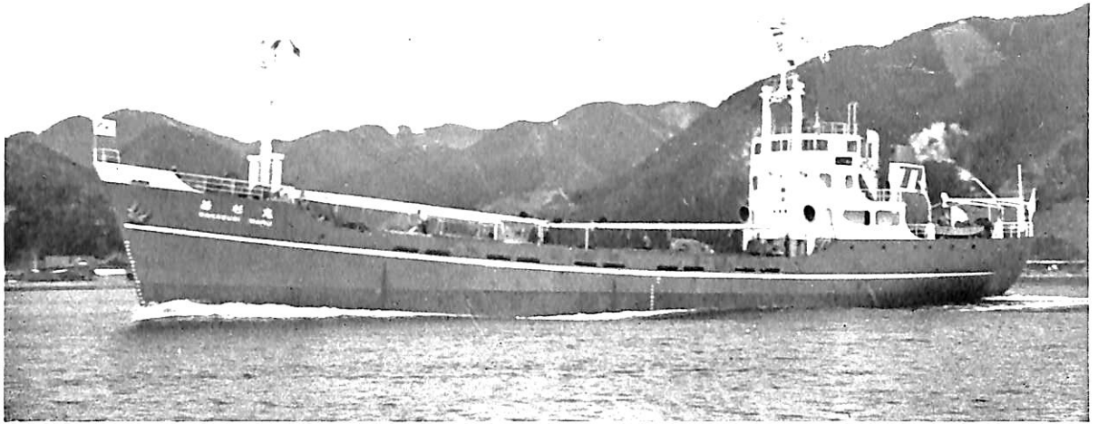
貨物船 若杉丸 九州汽船株式会社 幸陽船渠株式会社建造 起工 31-6-15 進水 31-12-2 竣工 32-1-31 垂線間長 55.00m 型幅 8.70m 型深 4.40m 満載吃水 3.96m 総噸数 642.51T 純噸数 312.31T 載貨重量 956.88Kt 貨物艙容積 (ベール) 1,073m 3 (グリーン) 1,142m 3 主機械 阪神内燃機製ディーゼル機関1基 出力(定格) 800BIP (315 RPM) 速力(最高) 12.8Kn (航海) 11.0Kn 航続距離 5,000 哩 船級 NK: NS* MNS* 乗組員 21名
