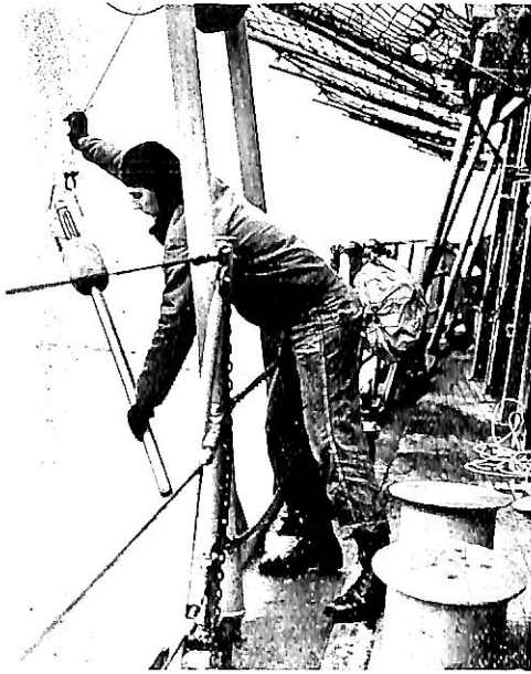
12,000呎の海底土質を採取器にて調査する隊員
