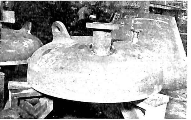
第8-11図 鏡板ヘノズルの熔接
