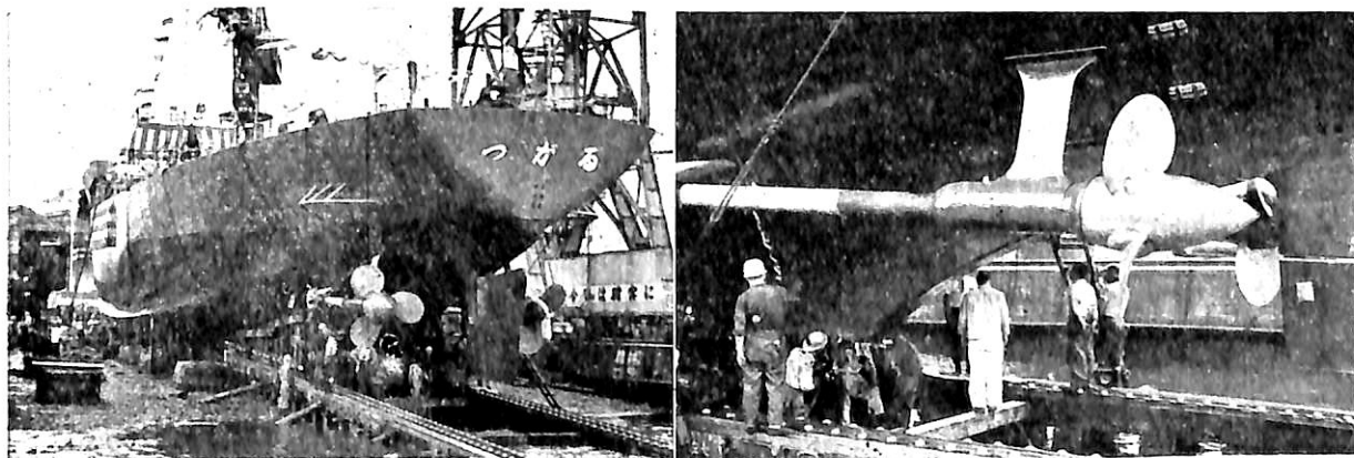
写真は進水式を控えた「つがる」に装備された可変ピッチプロペラ
