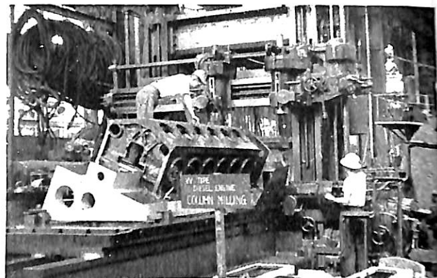
第5圖 機械加工中の架構
