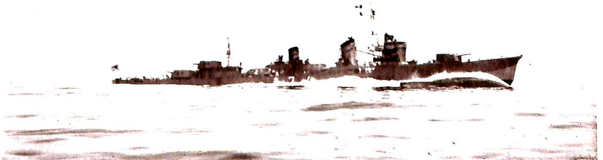
特等駆逐艦 野分 (陽炎型) (昭和16年4月, 舞鶴灣外) 全力35節航走中
