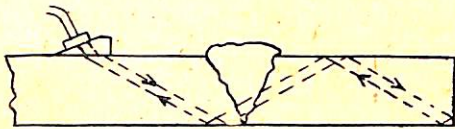
第6図 溶接箇所の検査
