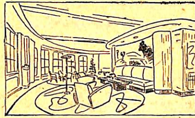
3 図 DONA ALICIA の Smoking Room. Promenade Deck 最后部にあり、窓は full height でその壁面は半圓形。油絵のある壁面はカーブして調和的、floor の絨氈とその模様は曲線で、すべてが曲面構成。又、装飾的な fire place 等を設けていない所に注意。
