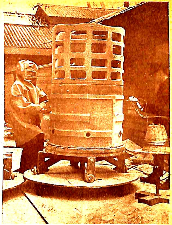
第10圖 シリンダ入子外面冷却水に触れる部分に亜鉛を吹付ける作業。右側の人の持っているピストル型の器具で亜鉛を溶かして吹付ける。
