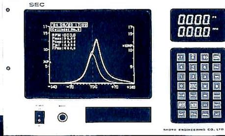
連続使用型センサーがエンジンの燃焼状態を常に監視します。
