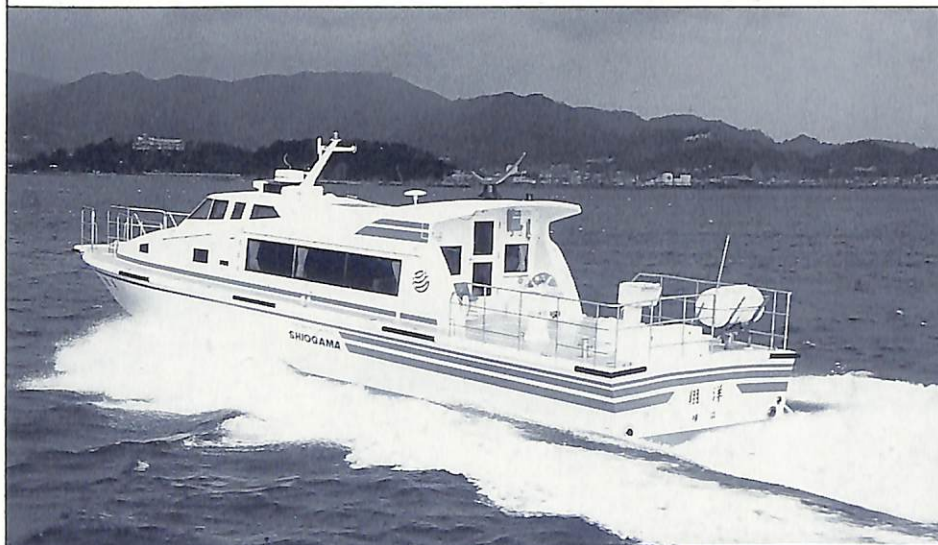
FRP. 単胴型一層全通甲板船/総噸数30T/乗組員20名/速力最大33kn
