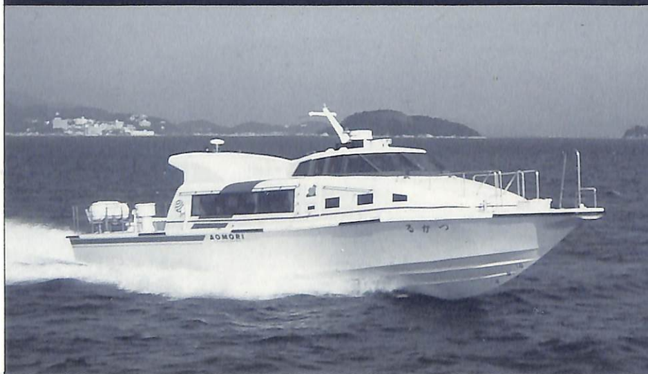
FRP. 単胴型一層全通甲板船/総噸数30T/乗組員20名/速力最大33kn
