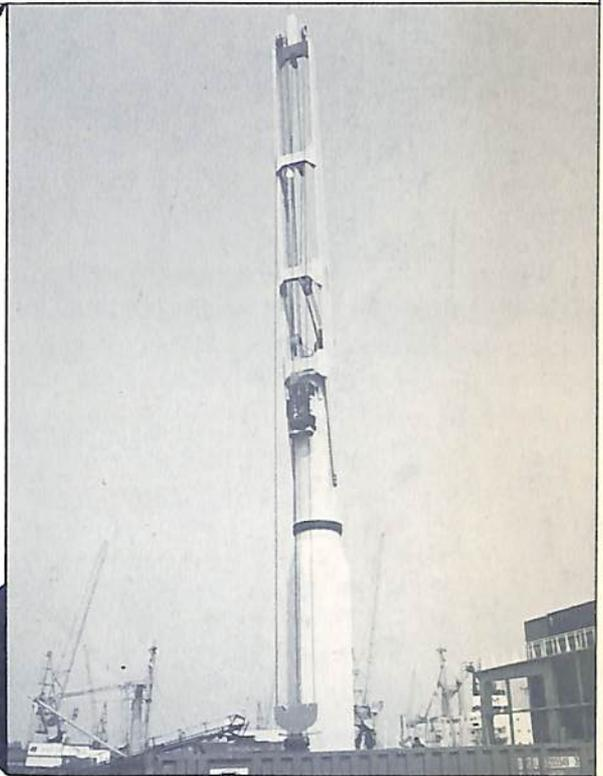
スリムタイプ L2クレーン (36~40T) 最少作業半径2.4m。
