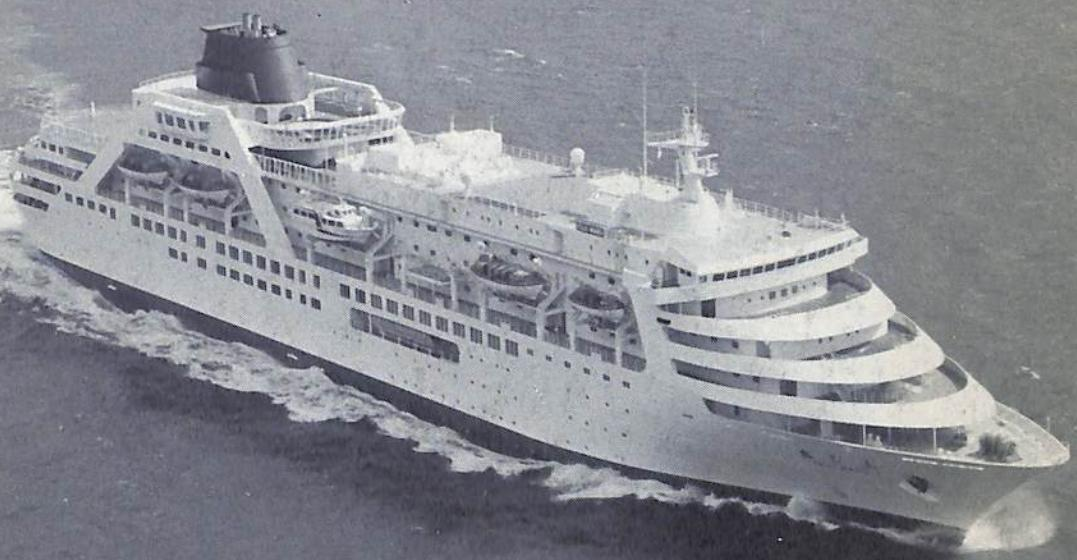
大阪商船三井船舶・商船三井客船向け / 三菱重工業・神戸造船所建造 / 総トン数23340T / 船客数603名 / 最高速22kn
