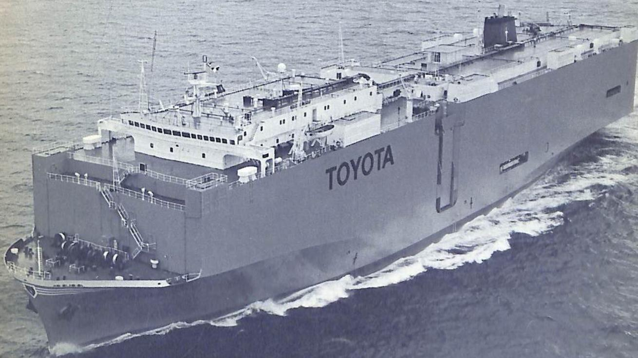
OSG Car Carriers, Inc. 向け自動車運搬船/載貨重量 16,141 t /Car 搭載数 5,347 台/速力(試運転最大) 20.29kn
