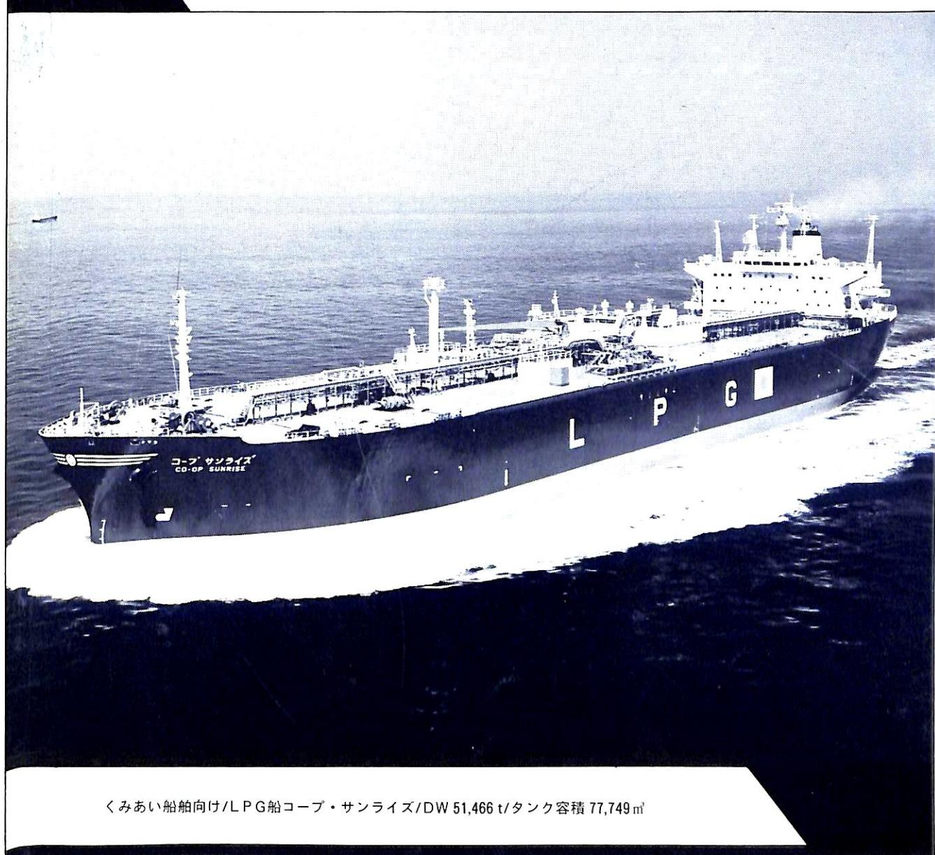
くみあい船舶向け/LPG船コープ・サンライズ/DW 51,466 t/タンク容積 77,749 m<sup>3</sup>
