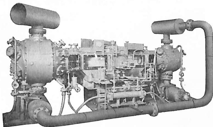
型式：水平対向1列2筒2段テフロンリング式(水冷)
